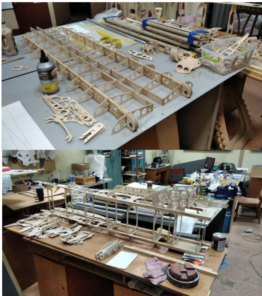
Рис.17. Безпілотний літак-носій: консолі крила у процесі збирання (зверху на рисунку); фюзеляж під час підгонки деталей після їх вирізання фрезеруванням (знизу на рисунку)
