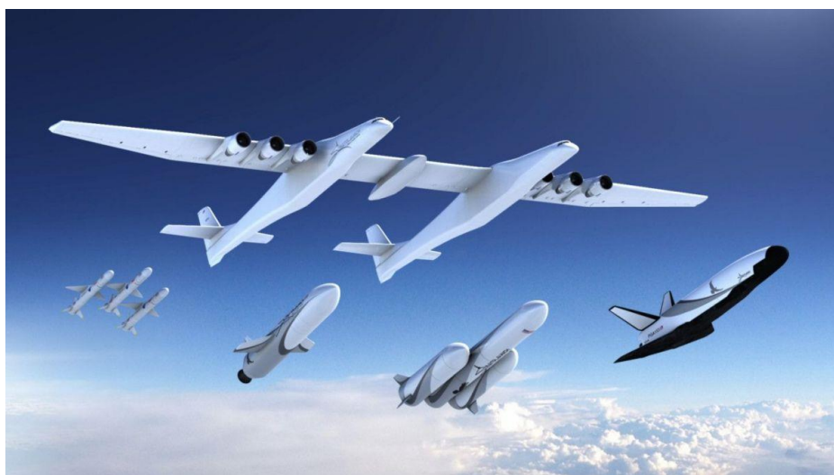
Рис.3. Система Stratolaunch (показані варіанти корисного навантаження)
